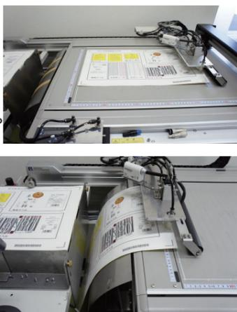
自動化するにあたってカットしたい印刷物とそれに対するカットデータをリンクさせる必要がありました。当システムでは印刷物にバーコードを印刷し、それをバーコードリーダーで読取、バーコードと同じカットファイル名を自動的に検索し出力することで解決しました。またこのシステムによりカットデータの送り間違えが発生しません。
